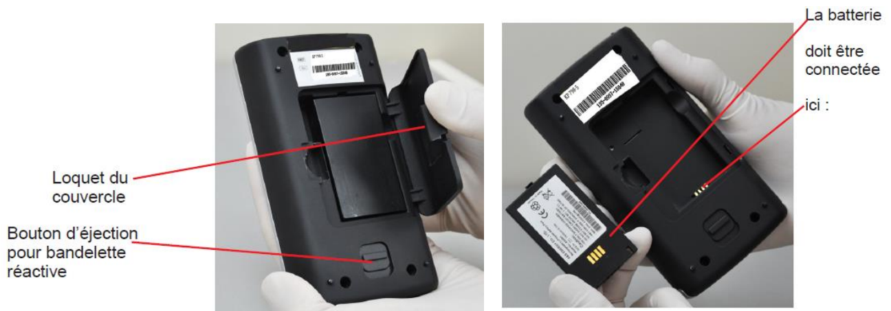
Figure 3. Remplacement de la batterie.
