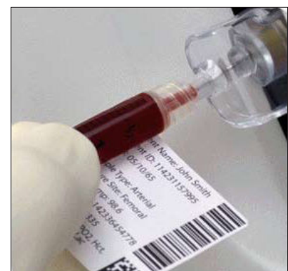
Figure 3.6 Seringue insérée dans le port de sécurité pour l'échantillonnage
