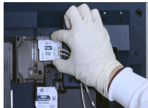
Figure 7.3 Retrait de la Reference Cartridge
